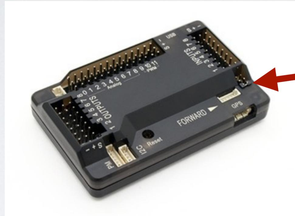
Antes de colocar la controladora debemos sacar el jumper situado en la parte delantera
